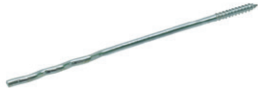
Per type spouwanker zijn verschillende lengtes beschikbaar voor een passende keuze bij de smalle baksteen, benodigde verankeringslengte en spouwbreedte.
