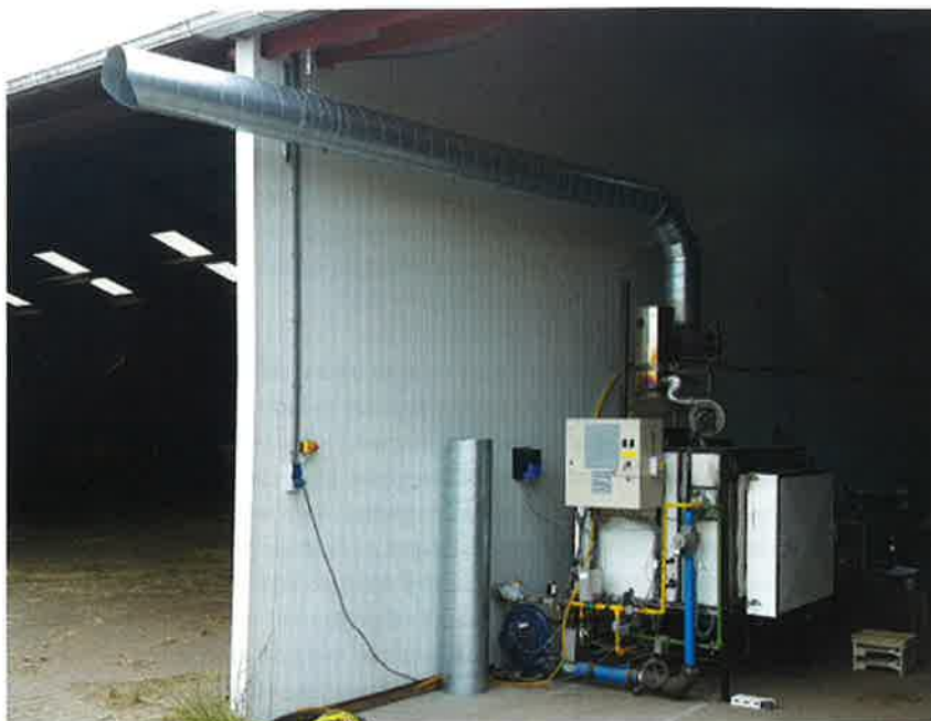
Foto 3: Laboratorium gasoven van TCKI, opgesteld bij een veehouder in Bathmen
