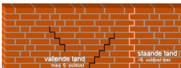
Fig. 1: voorbeeld met vallende en staande tand
