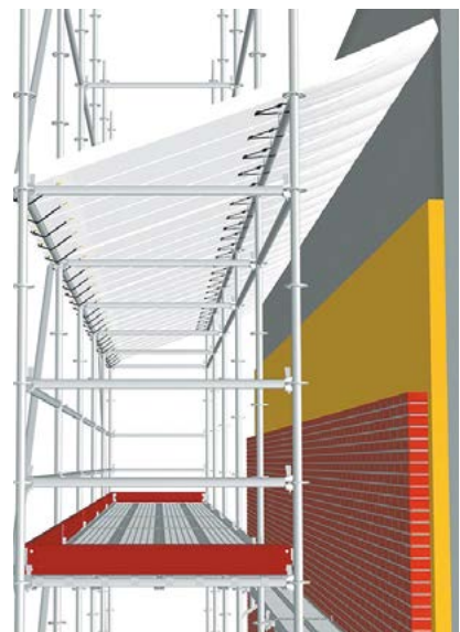
Werk bij voorkeur met een steiger met kap.
