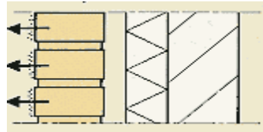
Water verdampt en de stoffen worden als witte uitbloei zichtbaar aan het oppervlak.
