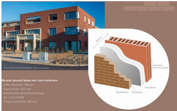
Massief passief bouw met volle baksteen, 240mm hardschuim en keramische binnenmuursteen, R_c = 9,2 . Totale muurdikte 430 mm (project Woonzorgcomplex Nimmerdor, Grijpskerke)
